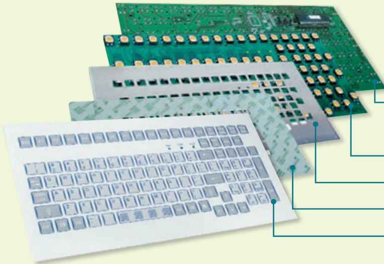
Schichtenaufbau einer Kurzhubtastatur
