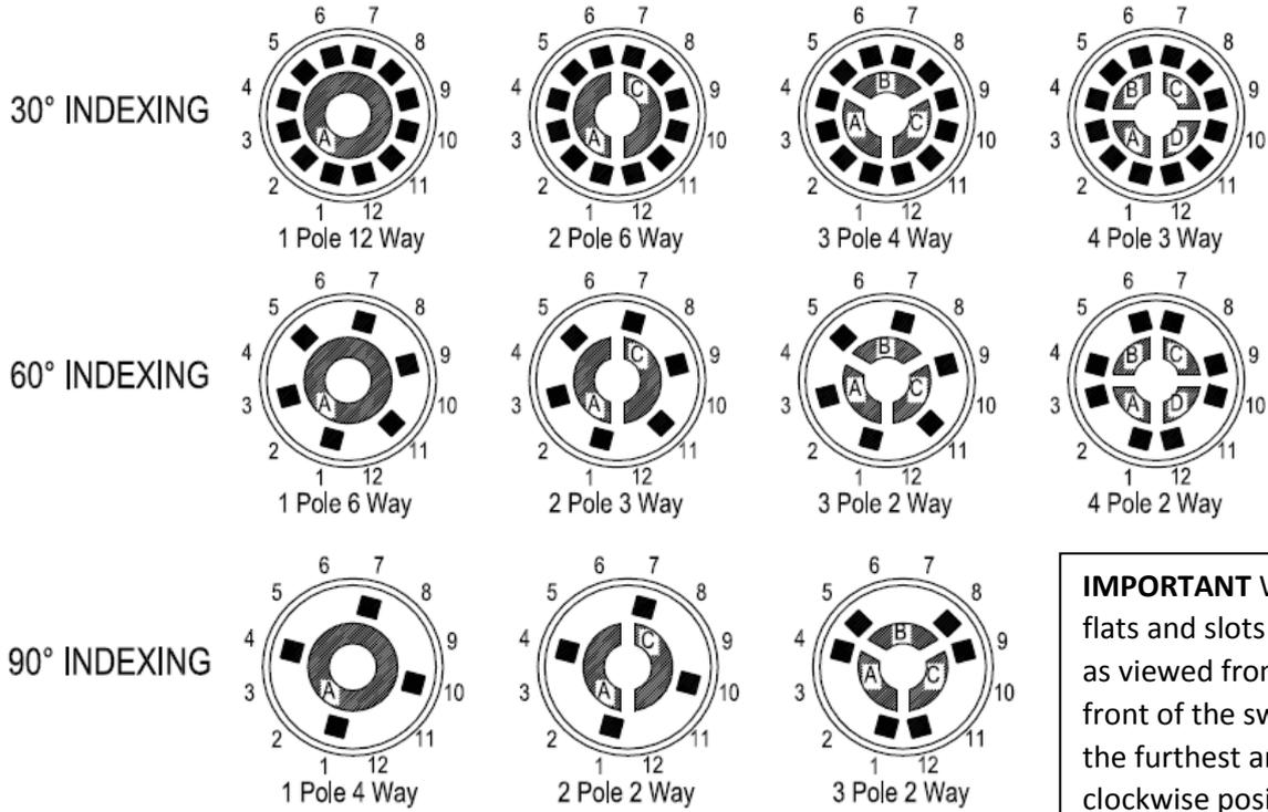
SPINDLE FLAT ANGLE - AVAILABLE IN 15° INCREMENTS
