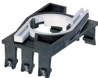
Lampenfassung und Schaltelemente werden zunächst in die Kupplung eingearastet. Die komplette Einheit wird dann auf das Betätigungselement aufgerastet. Zum Lösen muss der Bajonett-hebel gedrückt werden (gleichzeitig Sicherung gegen unbeabsichtigtes Lösen).
