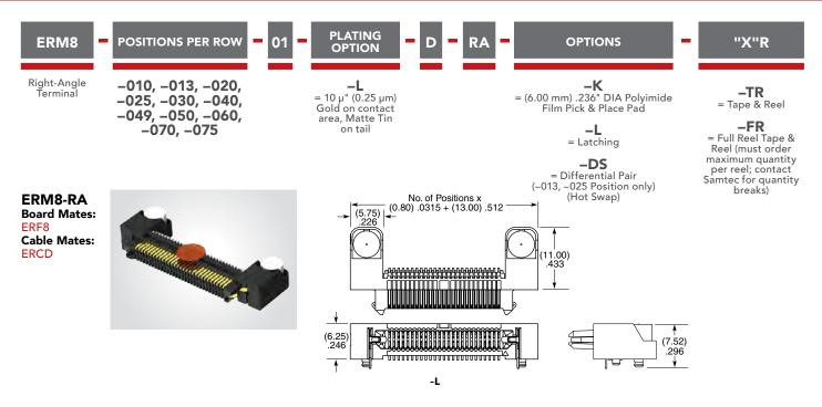
View complete specifications at: samtec.com?ERM8-RA
