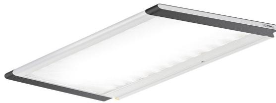
Die LED-Leuchte PL151 ist eine Hochleistungs-LED-Leuchte in einem extrem flachen Gehäuse. Durch eine spezielle verwendete Punkt-Prismatik, erzeugt diese LED-Leuchte blendfreies, flächiges Licht wodurch die Leuchtdichte reduziert wird und mehrfache Schattenbildung auf der Arbeitsfläche verhindert wird.
